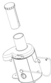
5. Закрепите защитный держатель с обеих сторон прибора, при этом вы должны услышать щелчки. Установите толкатель в загрузочную горловину.
