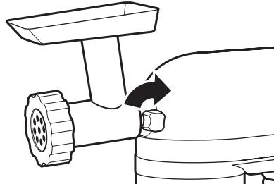
**4** Затяните ручку крепления, повернув по часовой стрелке, чтобы насадка была полностью закреплена на миксере.
