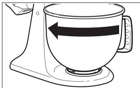
**3** Установите чашу в фиксатор. Осторожно поверните чашу в направлении часовой стрелки.
