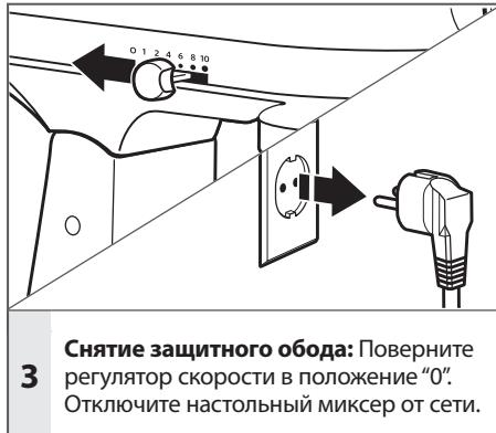
**3 Снятие защитного обода:** Поверните регулятор скорости в положение "0". Отключите настольный миксер от сети.
