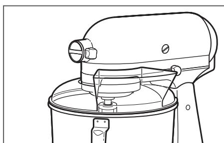
**1** Для достижения наилучших результатов вращайте защитный обод так, чтобы моторный блок закрыл U-образное отверстие обода. Разливочный носик будет как раз справа от фиксатора насадок, если смотреть прямо на миксер.
