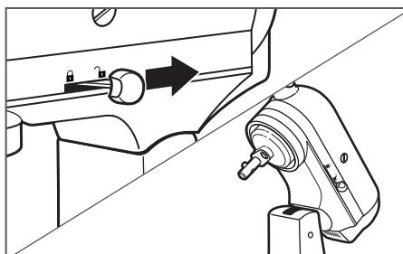
**2** Зафиксируйте рычаг в положении **Unlock** (Откр.) и отведите моторный блок назад.
