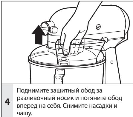
**4** Поднимите защитный обод за разливочный носик и потяните обод вперед на себя. Снимите насадки и чашу.
