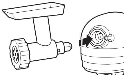
**3** Вставьте корпус с валом привода насадки в соединительную втулку так, чтобы конец вала плотно вошел в квадратное отверстие втулки. Может потребоваться некоторое вращение насадки в ту или другую сторону. Когда насадка займет правильное положение, штифт на насадке войдет в паз на кромке соединительной втулки.
