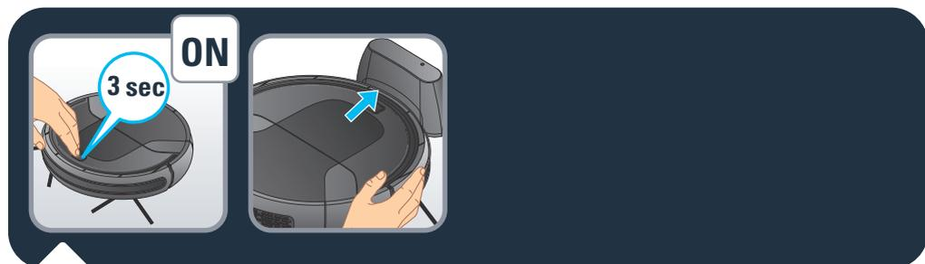
**RU** Чтобы зарядить робот, нажмите и удерживайте кнопку включения в течение 3 секунд. Поместите робот на зарядную станцию так, чтобы его контактные пластины касались клемм на зарядной станции.
