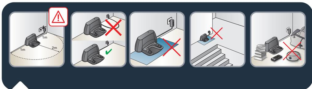
**RU** Устанавливая зарядную станцию, убедитесь, что с каждой стороны пустое пространство составляет 1 м и 2 м перед ней. Не устанавливайте зарядную станцию рядом с лестницей. Убедитесь, что кабель плотно вставлен в соответствующий разъем. Зарядная станция должна быть размещена на твердой поверхности. Не размещайте зарядную станцию на ковровых покрытиях.
