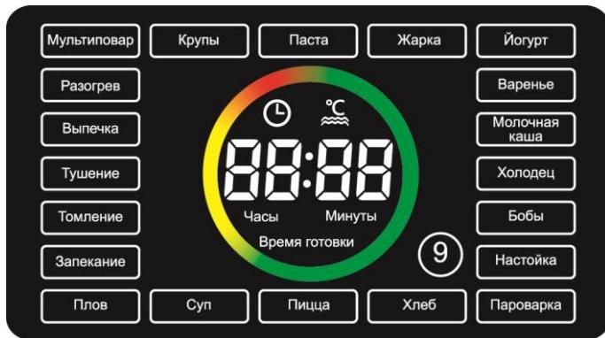
Після закінчення часу приготування прилад автоматично переходить у режим автопідігріву (винятком є програма “ЙОГУРТ”). На дисплей при цьому відображатиметься прямий відлік часу.
