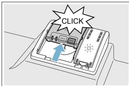
Камера для моющего средства открывается автоматически в зависимости от выбранной программы в самый подходящий для этого момент. Порошкообразное или жидкое моющее средство распределяется внутри прибора и затем растворяется, таблетка падает в предназначенную для нее подставку и растворяется там в нужной дозировке.
