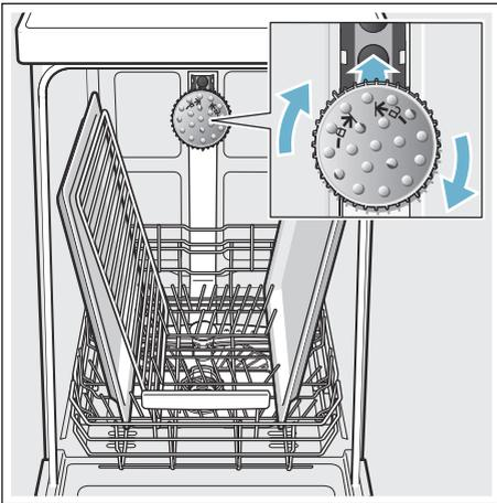
Чтобы струя воды смогла достать до всех деталей, противни следует располагать, как показано на рисунке (макс. 2 противня и 2 решетки).
