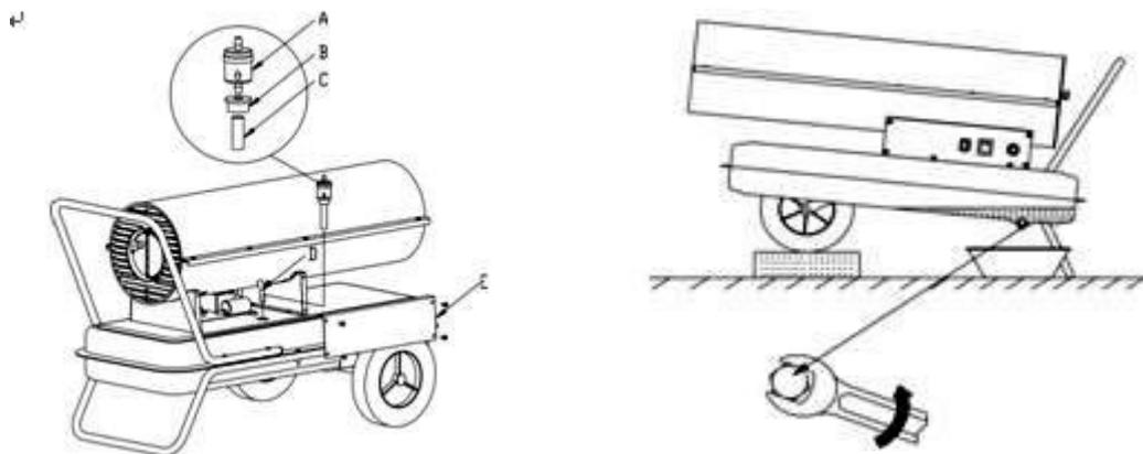
А - фильтр, В - заглушка, С - прозрачная трубка, D - вводная трубка, Е - боковая пластина
