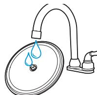
Промойте крышку под струей воды, очистите клапан. Дайте высохнуть и установите на место
