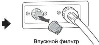
Очистите фильтр клапана впуска воды или переустановите шланги подачи воды.
