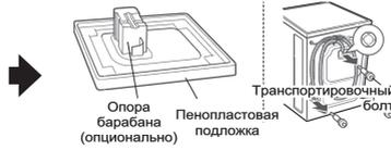
Снимите транспортировочные болты и опоры.
