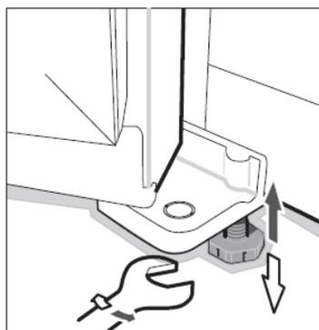
В транспортировочном положении ножки завернуты до упора. При установке отрегулируйте высоту ножек для выравнивания и устойчивого положения холодильника. Это возможно сделать с помощью ключа или вручную.
