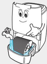
**Не погружайте основной блок устройства в воду и не распыляйте на него воду.**
