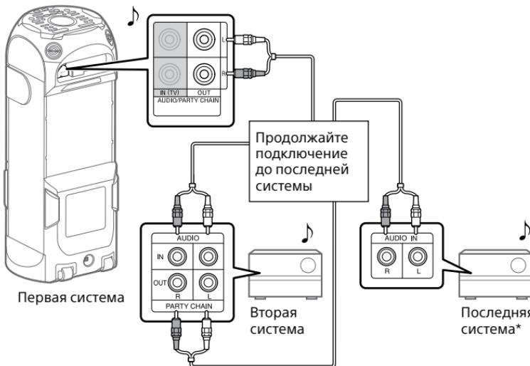
\* Подсоединяйте систему, не оснащенную функцией Wired Party Chain, в качестве последней системы, в противном случае цепочка остановится на этой системе. Обязательно выполните функцию аудиовхода на последней системе.
